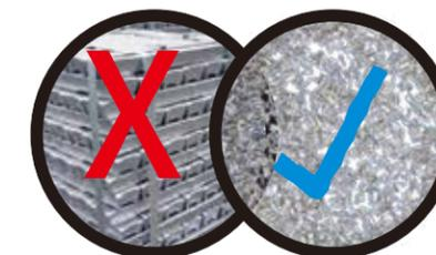
Keine Verwendung von Barren, die Magnesium Späne bzw. das Granulat kann mit einem Dosiergerät kontinuierlich automatisch zugeführt werden!
