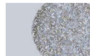
Magnesium im Anlieferzustand in Form von Spänen bzw. Granulat
