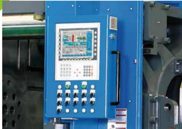
Der 10,4-Zoll-Touchscreen und der 500 MHz-Controller bietet dem Bediener eine intuitive, schnelle und einfache Programmierung.
