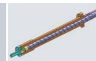
CAD-Schnittdarstellung der Plastifizierung bzw. des Aufschmelzaggregates
