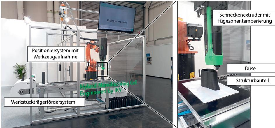
**Bild 1.** Hybride Fertigungszelle des IKV im Live-Betrieb auf der Hannover Messe 2018 bei der Fertigung eines Strukturbauteils mit einer Produktionsgeschwindigkeit von 6g/min (© IKV)
