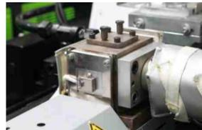
Verbindungsbereich zwischen Spritzgießmaschine und CDS
